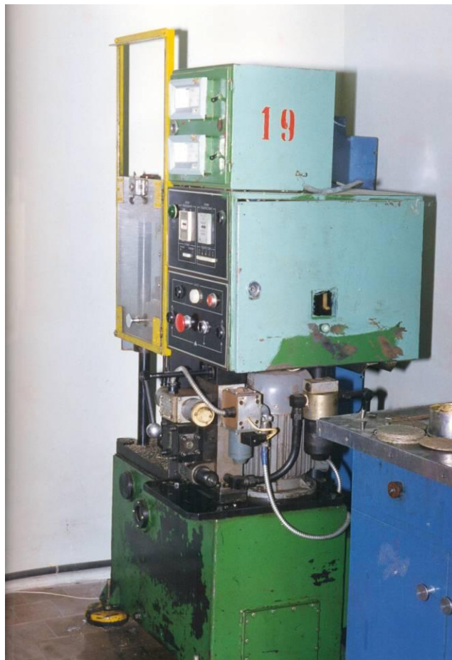
Пресс гидравлический с усилием прессования 12т.
