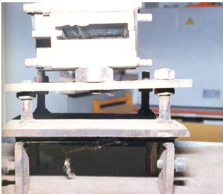
Экструзионная головка для получения методом экструзии профиля «наличник».
