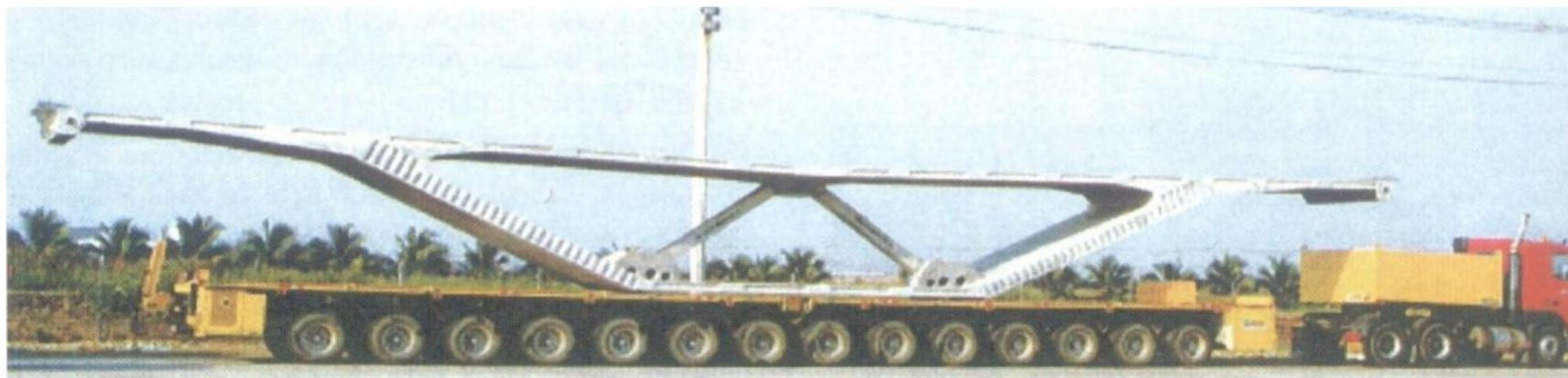
Железобетонный пустотелый элемент скоростной автомобильной многорядной трассы при транспортировке на место строительства. Видны отверстия для ввода стальных стягивающих канатов.
