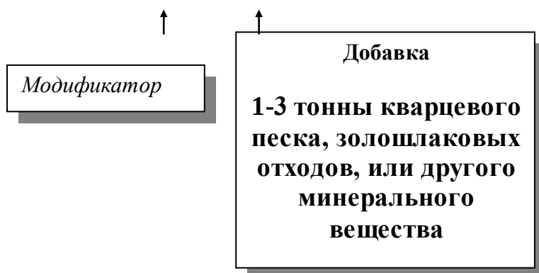
Рис. 2. Базовая технологическая схема производства малоклинкерных наноцементов
